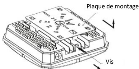
2. Utilisez les vis pour fixer la plaque de montage à la boîte de jonction intégrée.
