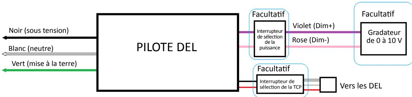
**Remarque :** Si la tension de secteur est de 208 V ou de 240 V, le second point chaud d'alimentation doit être raccordé au fil blanc neutre.
