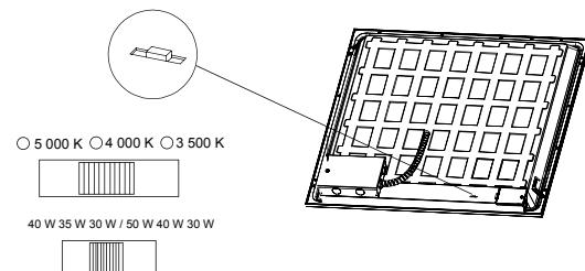
**Remarque :** Par défaut, tous les modèles sélectionnables sont configurés à la puissance maximale et à 4 000 K.
