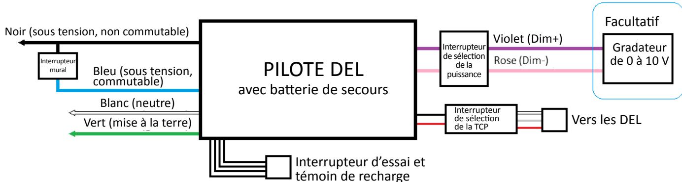
**Remarque :** Si la tension de secteur est de 208 V ou de 240 V, le second point chaud d'alimentation doit être raccordé au fil blanc neutre.
