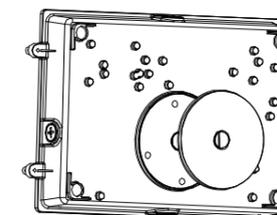
**5** Enlever la pellicule du côté adhésif du coussin de mousse et le coller au dos de la plaque de montage. Retirer les sections intérieures pour les vis
