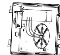
**6** Passer le fil à travers l'orifice de la plaque arrière pour la prise
