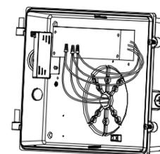
**8** Raccorder le luminaire à l'alimentation selon le schéma de câblage ci-inclus
