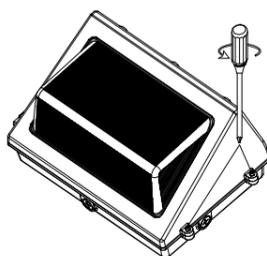
**1** À l'aide d'un tournevis cruciforme no 2, desserrer les vis du couvercle
