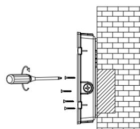
**7** Mettre à niveau et fixer le bas du boîtier sur la boîte octogonale avec les vis et le niveau à bulle de la plaque arrière
