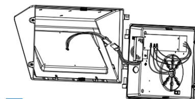
**9** Accrocher le couvercle du luminaire sur la plaque arrière montée et réinstaller le raccordement du couvercle
