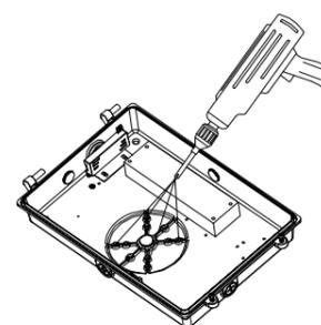
**4** Percer des trous à travers la plaque arrière qui correspondent aux vis nécessaires au montage de la boîte de jonction
