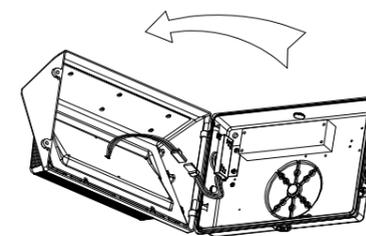
**2** Ouvrir le luminaire, débrancher le raccord du couvercle et retirer le haut du couvercle de la plaque arrière du luminaire
