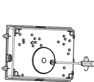
**3** À l'aide d'un grand tournevis cruciforme ou à tête plate, retirer l'alvéole défonçable de la prise fileté de 1/2 po de la plaque arrière
