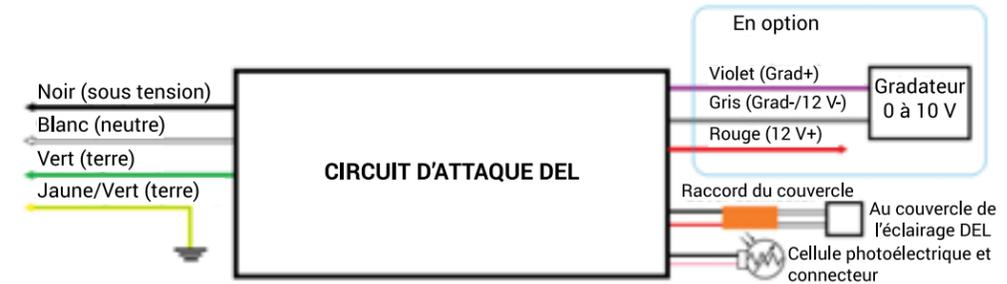
La cellule photoélectrique est installée dans l'alvéole défonçable du côté de la charnière et raccordée selon le schéma de câblage.
