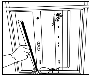
2 Instalar la Tira de LED, utilizando el soporte magnético
