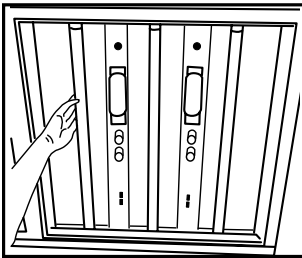
1 Desmontar los tubos fluorescentes y el balasto
