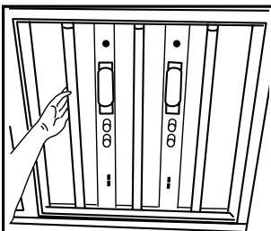
1 Retirer les tubes fluorescents et le ballast.
